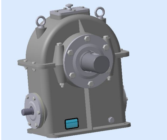
Рис.4.68. Результат расчёта червячного одноступенчатого редуктора
